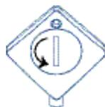
Pour insérer la batterie il faut dévisser le couvercle au dos de la sonde à l'aide d'une pièce de monnaie, insérer la pile en respectant la polarité (+ au dessus) puis revisser le couvercle.
